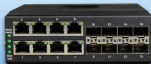
工业轨式 管理型8路千兆电+8路千兆SFP光口
