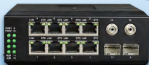
工业轨式管理型 带bypass功能 8路千兆电+4路千兆光口交换机
