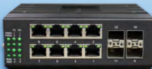
工业轨式管理型 8路千兆电+4路千兆光口+4路串口交换机
